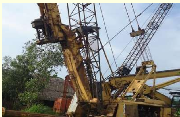
MÁY KHOAN CỌC NHỒI
